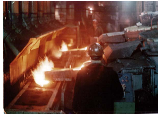
Дозоване електромагнітне розливання чавуну на автоматичній формувочній лінії
