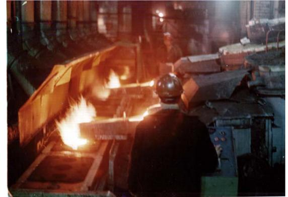
Дозированная электромагнитная разливка чугуна на автоматической формовочной линии
