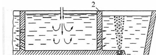
Схема універсальної фільтраційної системи удалення неметалічних включень в промковше:
