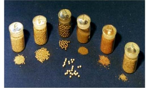
Комплекс дроболитейного оборудования типа "Град" производительностью 0.4 - 5.0 тыс. т. дробы в год размещается на площади 50 - 250 м<sup>2</sup> с привязкой к существующему плавильному оборудованию, энергоснабжению и коммуникациям. Выход годной дробы размером 0.5-3.5 мм до 85% и выше. Твердость дробы от 30 до 65 HRC.
